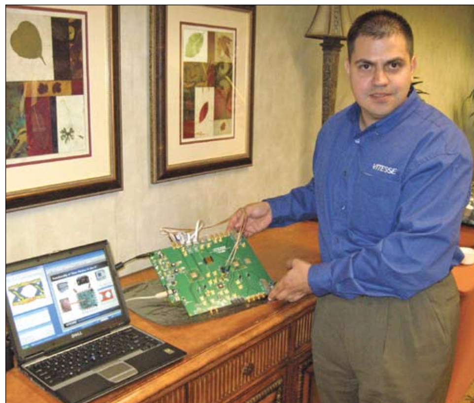
VScope fungerer meget på samme måde som en BER (bit error rate) test, og chippen indeholder både trafikgenerator, analysator og skopfunktioner, oplyste Juan Garza, der her demonstrerer funktionen på et demo board
